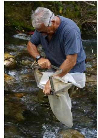
Figure 6 Prélèvement des macro-invertébrés benthiques au filet surber (Source :JI)
