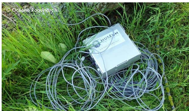
© Océane Roquinarç'h Détecteur et enregistreur d'ultrasons (SM2BAT+).
