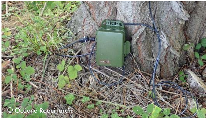
Détecteur et enregistreur d'ultrasons (SM4).
