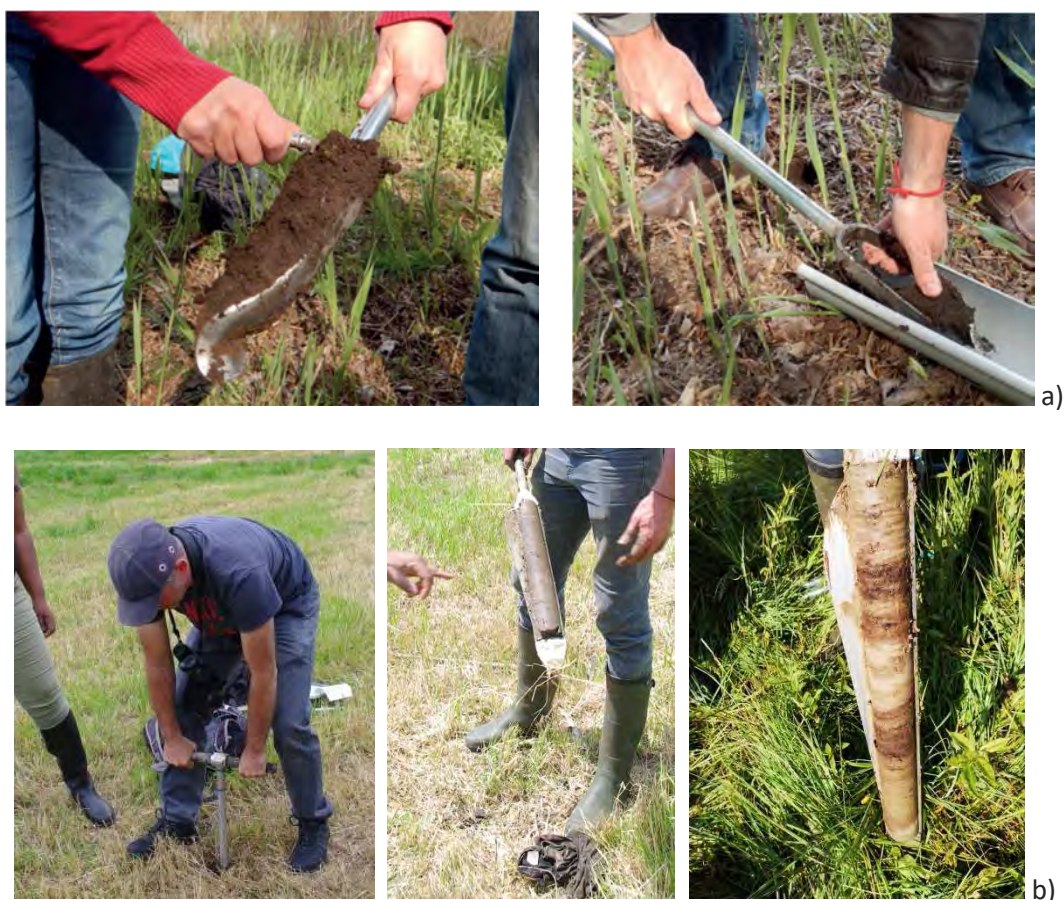
Figure 9 : illustration des sondages pédologiques avec une tarière edelman (a) et un carottier russe (b).
