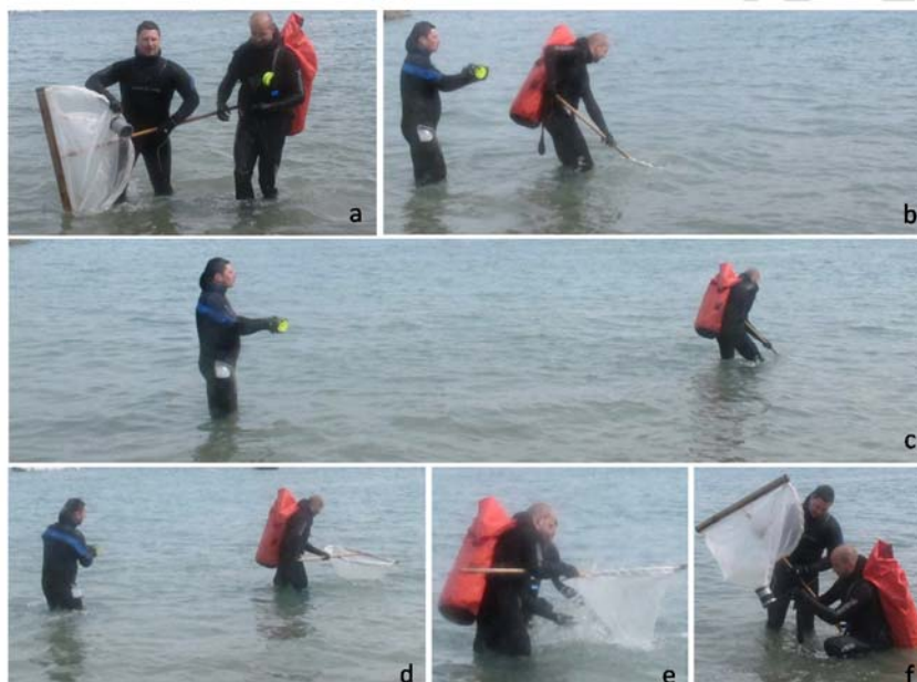
Figure 9. Illustration de la mesure des 10 mètres au moyen d’un dévidoir de plongée, organisation du binôme à l’haveneau (chronologie : a- mise en place ; b- début du trait ; c-déroulement des 10 mètres ; d- rembobinage des 10 mètres ; e- rinçage de l’haveneau ; f- récupération de la chaussette-collecteur).
