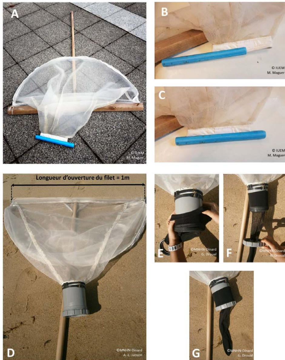
Figure 1. Haveneau (ouverture : 1 m ; maille du filet : 1 mm) dont l'extrémité est équipée d'une pince (A à C) ou d'un collecteur ajustable et interchangeable (D à G).
