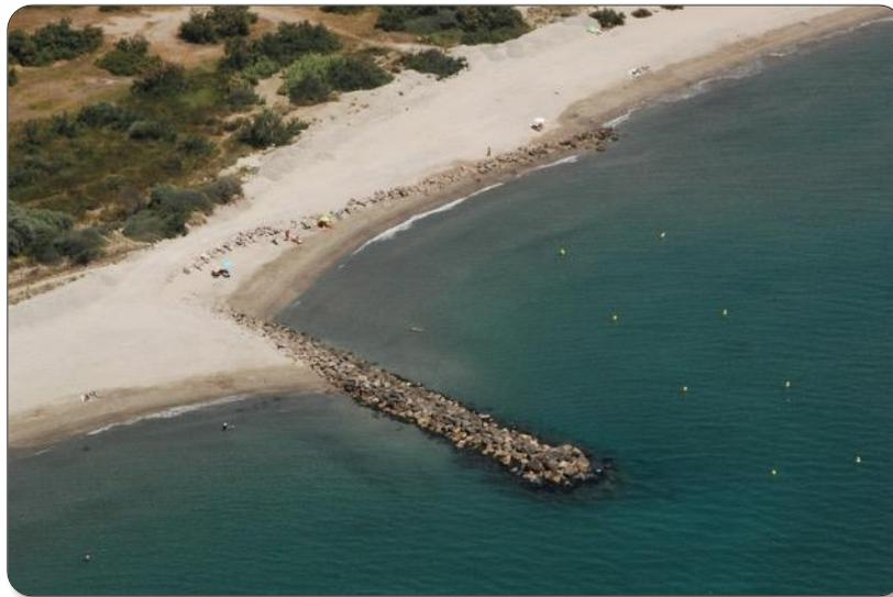
Figure 8 : Effet d'un épi sur l'érosion de la plage (© EID Méditerranée)
