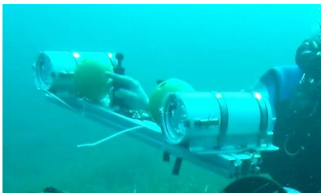
Figure 15. Système stéréoscopique testé dans le Parc National des Calanques de Marseille en août 2020 équipé de deux caméras GoPros Héro 6 dans des caissons et de deux bouées oranges pour la stabilisation sous l'eau (a) et photographie du cube de calibration SeaGIS utilisé pour calibrer le système stéréoscopique (b).
