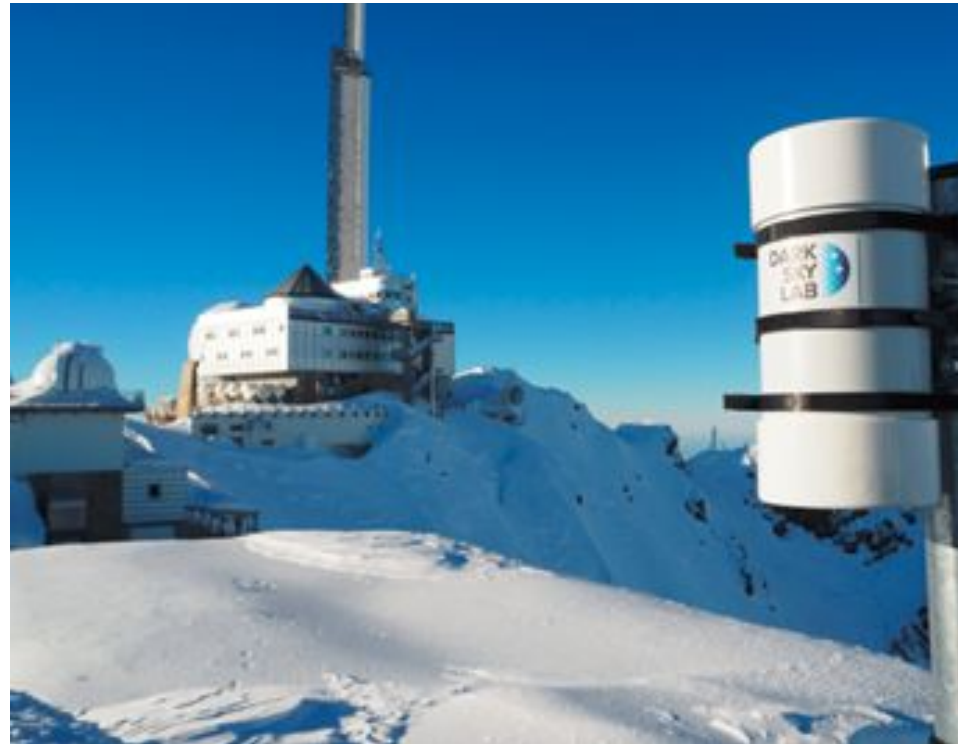
Appareil de mesure automatique Ninox tel qu'installé près du Pic du Midi
