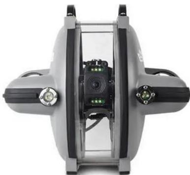
Figure 15 : Photographie du ROV (Remotely Operated Underwater Vehicle) testé en juin 2020 à Roscoff et Douarnenez
