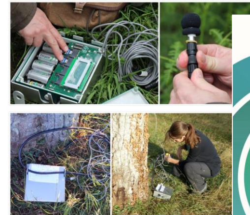
Exemple de protocole : mise en place d'un dispositif d'enregistrement ultrasonore pour une étude sur les chiroptères. © Camille Gazay
